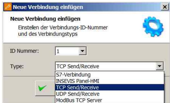
Die erstellte TCP-Verbindung wird mit der IP-Adresse des Kommunikationspartners konfiguriert.
